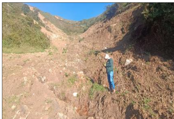
IMAGEN N°2: Deslizamiento de tierra y lodo en inicio de quebrada, con acumulación de material en la parte baja, indicando alto riesgo de flujos
